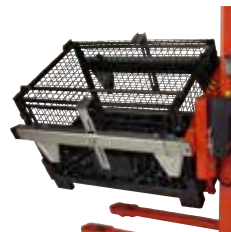
Rotator med justerbare boksholdere med beslag og 2 sæt sidestøtteplader.
