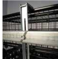
Boksholdere kan vælges med eller uden beslag (ekstra udstyr). Beslag anbefales ved vip over 60°.
