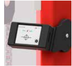
Touch display. Logfunktion. Muligt at programmere f.eks. flere stop, drejevinkel, hastighed, rotation. Viser fejlmeddelelser.
