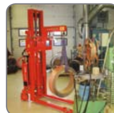
Metalruller løftes ind i en stansemaskine.
