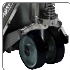
Vognene har to antistatiske hjul af vulkollan, der afleder statisk elektricitet.
