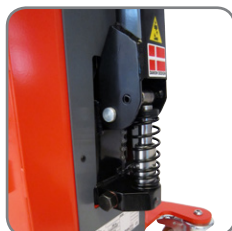
LogiQ 300 har hydraulikpumpe, som minimerer antallet af pumpeslag.
